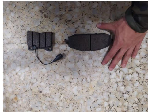
Ilustración 10: Pastilla de freno VAMTAC (Izquierda) y Aníbal (Derecha)
