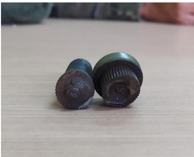
Ilustración 4: Perno de rueda roto
