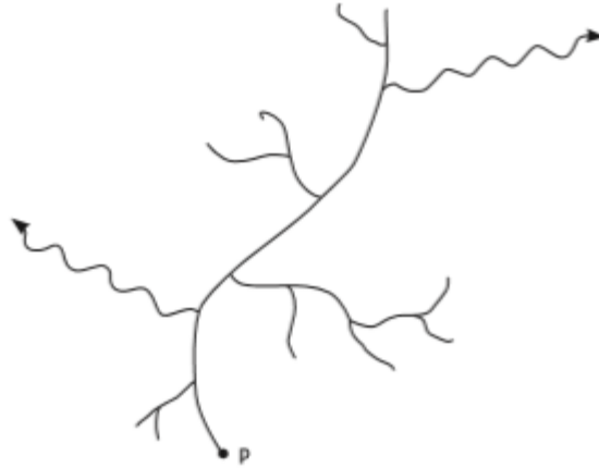
Fig. 1.3: Partícula cargada en el punto P es frenada en el medio, originando tanto partículas cargadas secundarias mostradas por la ramificación como fotones representados mediante líneas onduladas. [15]
