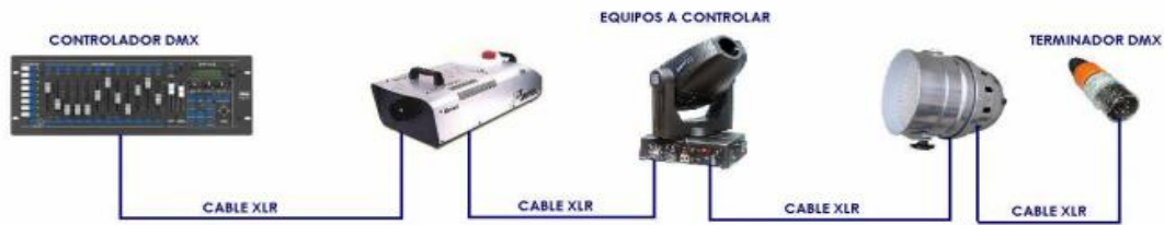
Ilustración VII. Arquitectura de red DMX512. Fuente:
