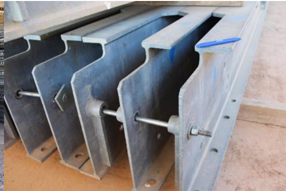
Fotografía 40. Detalle de pasador de unión confección paquetes Fuente: propia
