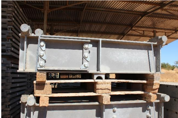
Fotografía 77. Detalle unión viga con diafragma Fuente: propia
