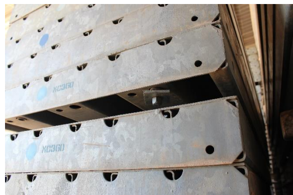
Fotografía 44. Detalle de pasador de unión confección paquetes Fuente: propia
