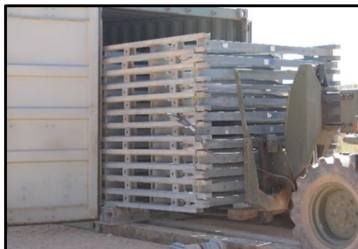
Fotografía 117. Detalle de maniobra de carga de contenedor de 20' de apertura por un solo extremo Fuente: propia
