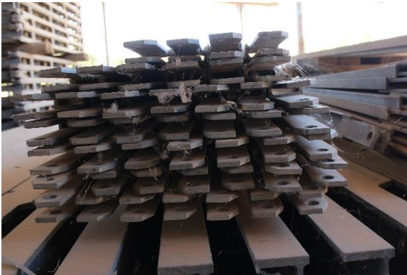
Fotografía 53. Detalle bulto de diagonales Fuente: propia
