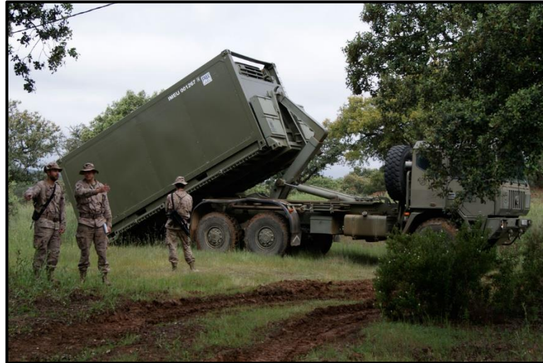
Fotografía 24. Detalle descarga contenedor frigorífico con plataforma VEMPAR Fuente: Intranet ET
