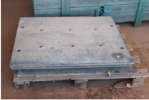
Fotografía 63. Detalle bulto de placas de asiento triple Fuente: propia
