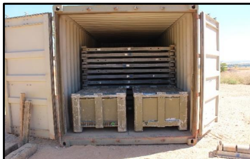
Fotografía 118. Detalle de dos bultos de paneles y dos CPR1 dentro de Contenedor ISO 20' de carga por un solo extremo Fuente: propia
