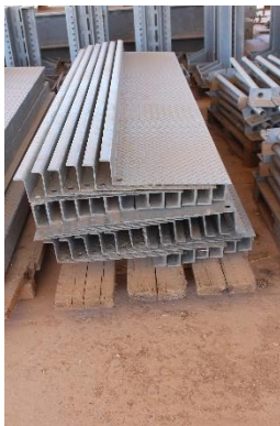
Fotografía 81. Detalle confección bulto en altura Fuente: propia
