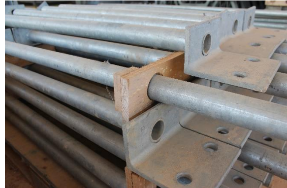
Fotografía 84. Detalle de soporte ad hoc para poste pasamanos Fuente: propia
