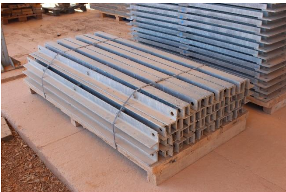
Fotografía 59. Detalle bulto de tornapuntas Fuente: propia
