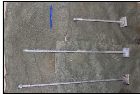
Fotografía 2. Barras de unión Fuente: propia
