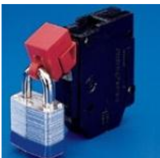
Dispositivo para interruptores con maneta. Bloquea la maneta para impedir el rearme del equipo y permite colocar el candado.
