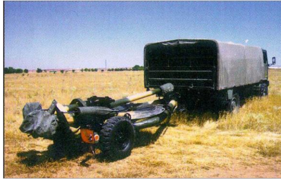
Figura 13: Obús Light Gun en posición de plegado.
