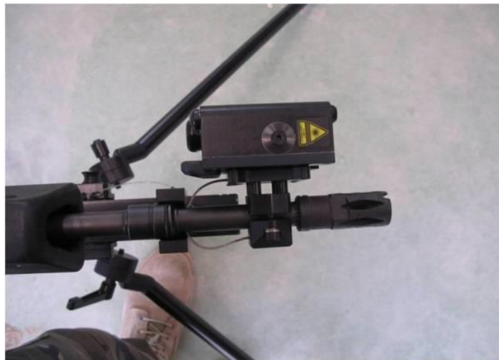
Figura 22. Emisor láser acoplado a cañón de HK G-36 E.
