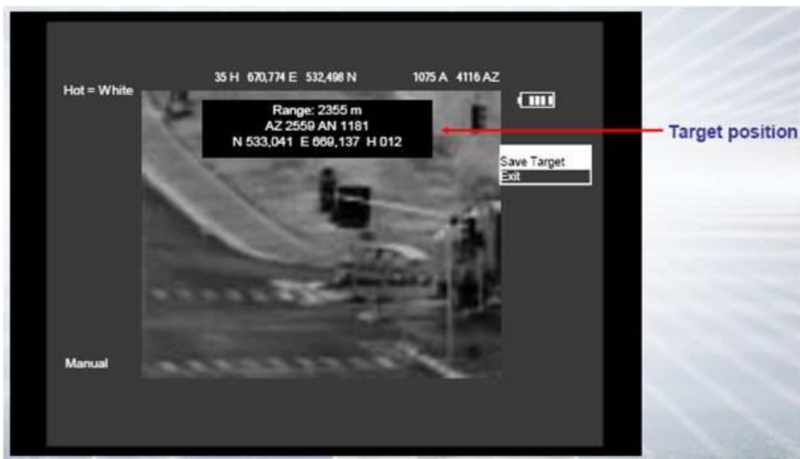
Figura 4: Designación laser de la cámara térmica Coral-CR
