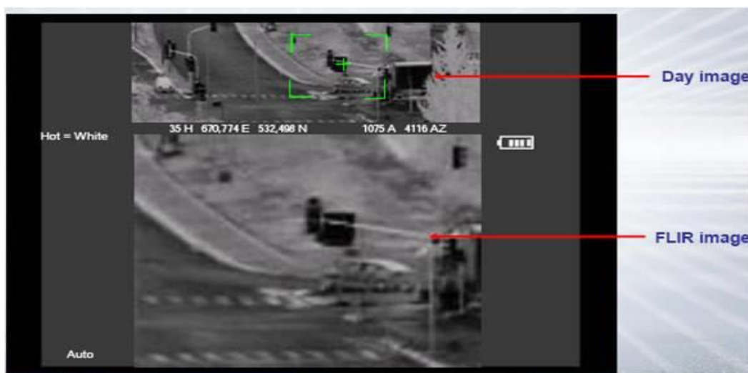
Figura 5: Capacidad dual de la cámara térmica Coral-CR
