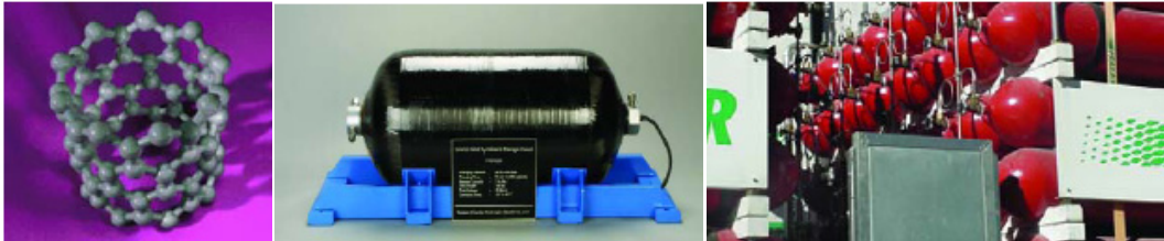
Figura 29. Diferentes sistemas de almacenamiento de hidrógeno: nanotubos de carbono, hidruros metálicos y tanques a presión
