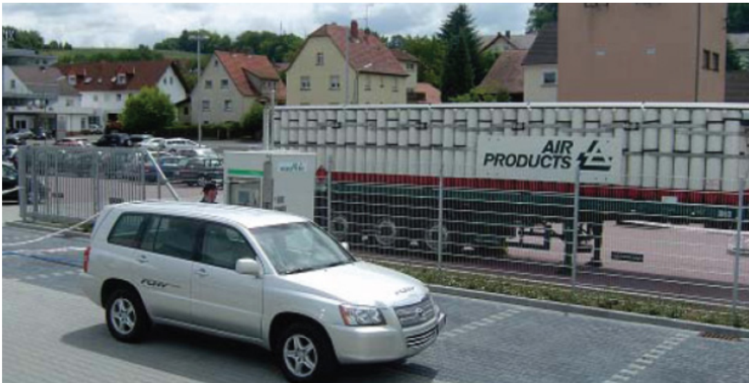
Figura 41. Plataforma móvil para el almacenamiento de hidrógeno a 200bar
