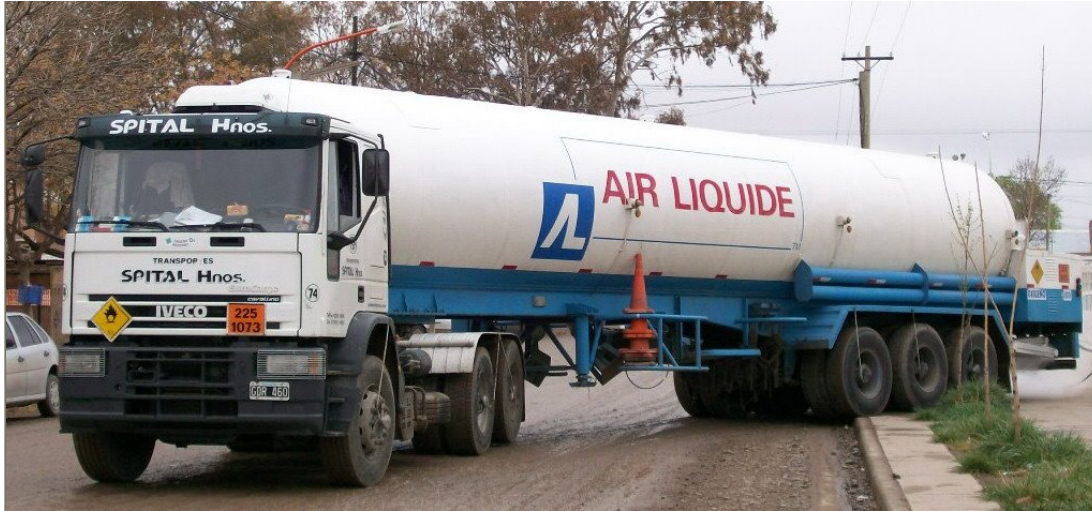
Figura 23. Vehículo industrial que transporta hidrógeno en estado líquido
