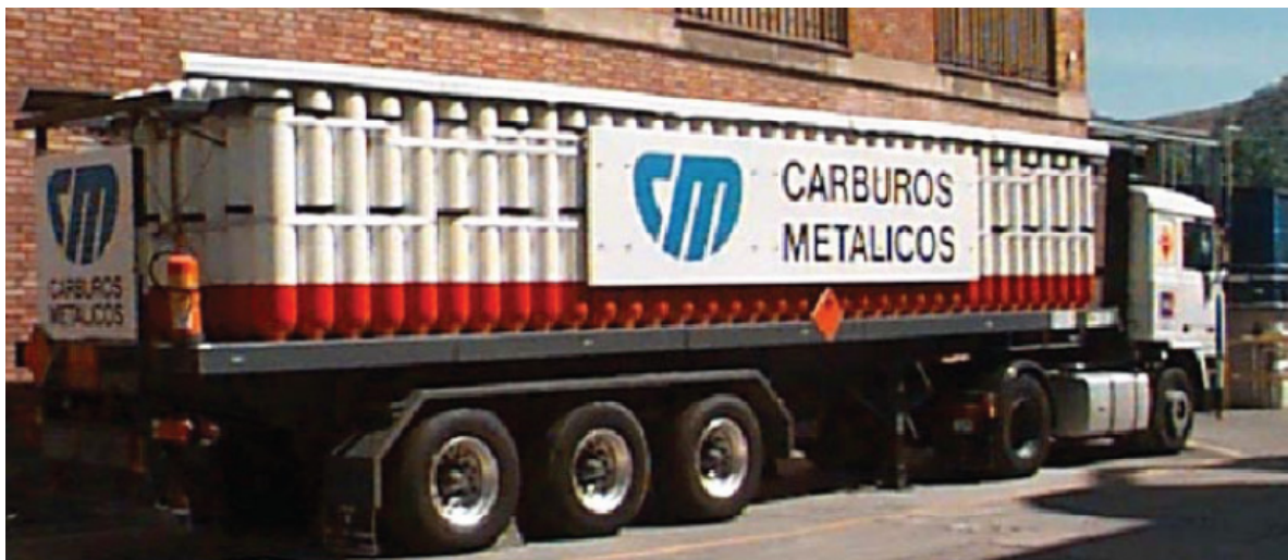
Figura 22. Camión con plataforma para la distribución de hidrógeno
