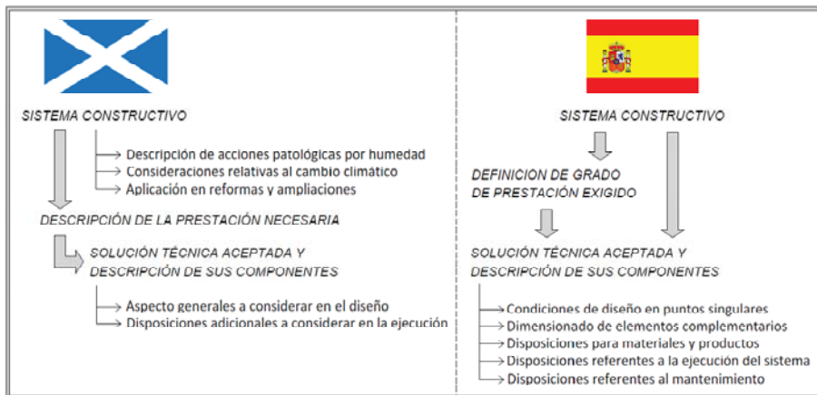
Figura III.44.- Diferencias en estructura organizativa de normativa escocesa y española. Cualquier solución alternativa debe ser previamente evaluada y homologada por el ente legislador.
