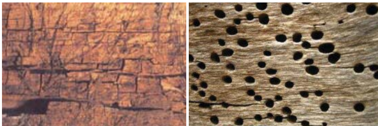
Figura II.28.- Pudrición por efecto del ataque de hongos a la celulosa de la madera y galerías realizadas por la acción de insectos xilófagos en el mismo sustrato.
