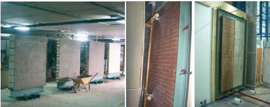
Figura III.37.- Probetas de ensayo desarrolladas por el Instituto Valenciano de la Edificación en el marco de la investigación prenormativa previa a la publicación del CTE, mediante UNE-EN 12865:2001 (www.five.es).
