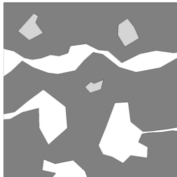
Figura II.95.- Composición de un material poroso típico. Matriz sólida (oscuro), porosidad cerrada (gris) y porosidad abierta (blanco). Solo la porosidad abierta está sometida a la acción de la humedad exterior, supuesto una matriz sólida inerte a la acción exterior.
