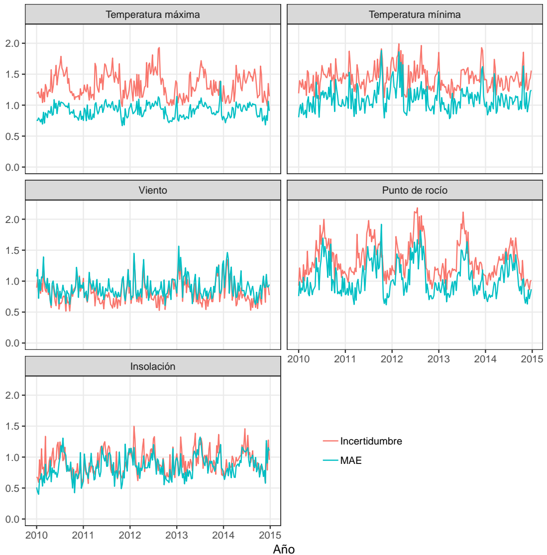
Figura 5.20: Comparación entre el error absoluto medio (MAE) y la incertidumbre (en forma de desviación típica) para el período 2010-2014.
