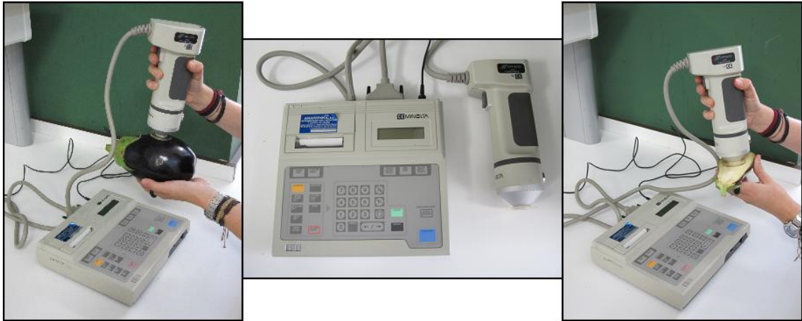
Figura 19. A la izquierda medida del color externo, en el centro colorímetro y a la derecha medida del color interno.
