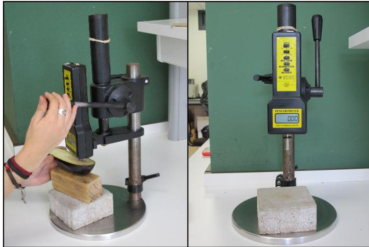
Figura 18. A la izquierda ensayo de penetración, y a la derecha penetrómetro digital.
