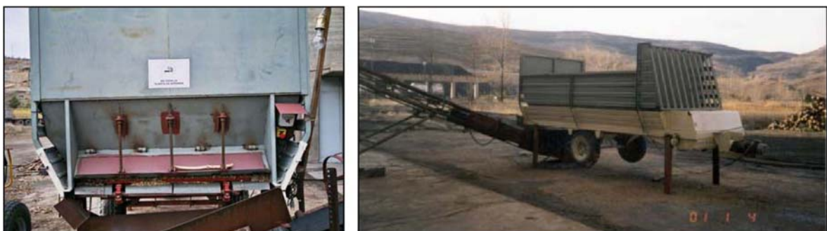
Figura 3.15. Tolva de almacenamiento de astillas.
