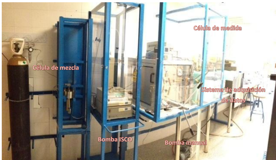
Figura 9: Instalación experimental para la medida de velocidades del sonido.
